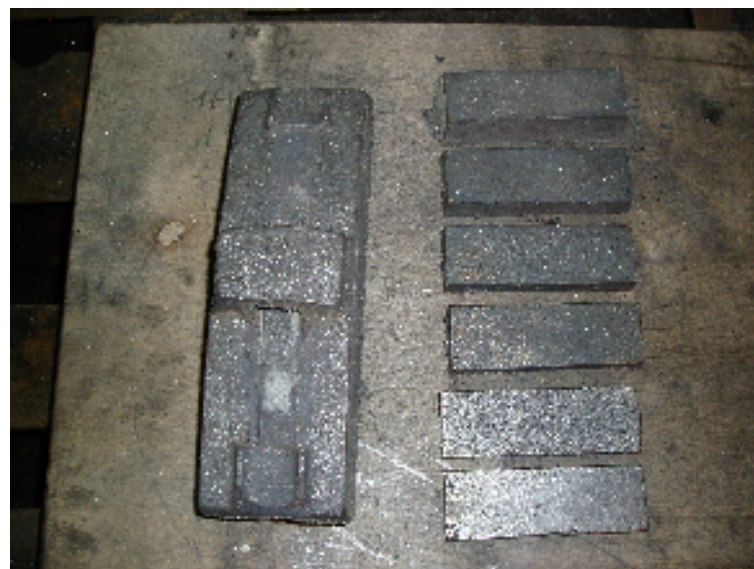
Bild 4. Testgussteile (Treppengestalt) und Abguss des Bremsklotzes (Phosphorgusseisen).
