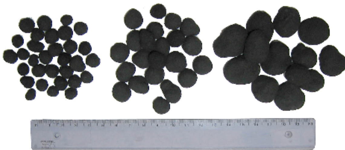
Bild 5. Granulate aus den dem Entstaubungsprozess von Bentonitsanden entnommenen Stäuben
