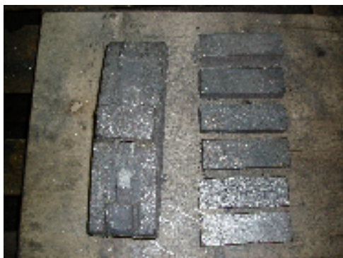
Rys. 4 Odlewy testowe schodkowe oraz odlew klocka hamulcowego (żeliwo fosforowe)
