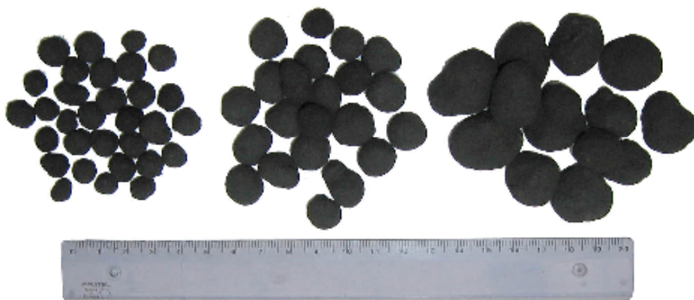
Rys. 5. Granulaty uzyskane z pyłów z odpylania mas z bentonitem
